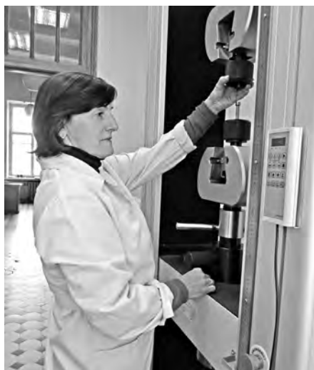
Начальник лаборатории механических испытаний и металловедения Г.А. Турыгина демонстрирует работу испытательной машины с компьютерным управлением
