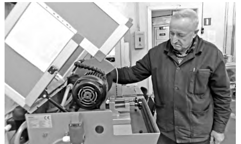
Слесарь В.Л. Щуров производит работы на новом отрезном металлографическом станке с охлаждением
